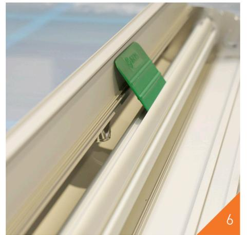
6 Die Klemmleiste hochklappen und mit der Rake fixieren.
