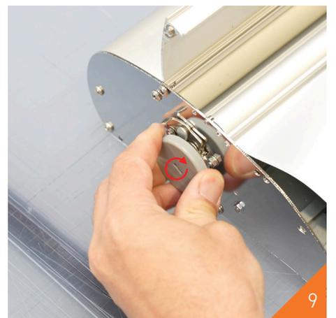
9 Das Spannrade an der linken Seite 15 Mal vollständig drehen. Sollte sich das Rad sehr schwer drehen lassen, ist die Kassette bereits genügend gespannt.
